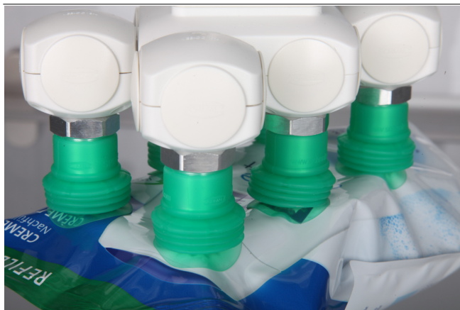
Сильфонные присоски SPB4, используемые для перемещения продуктов в мягких упаковках
